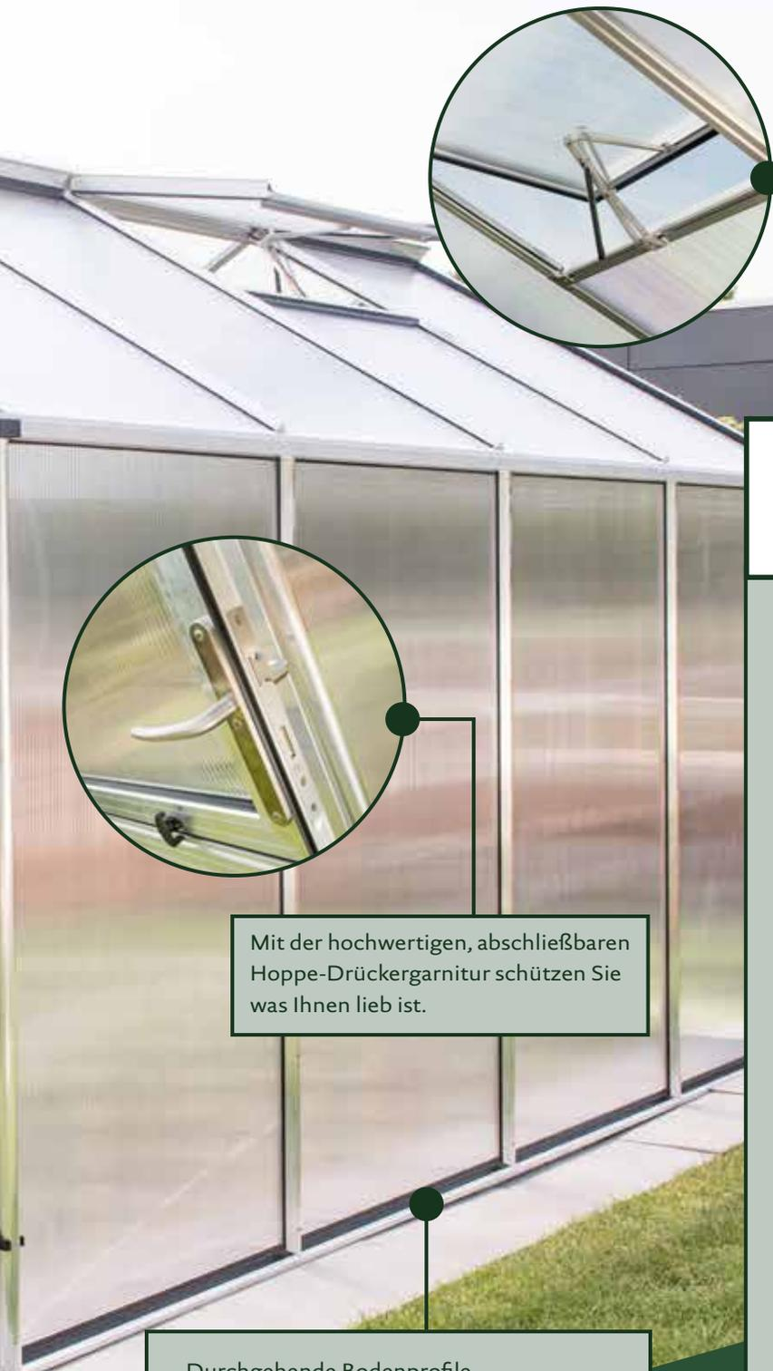
Breites Dachfenster mit automatischem Fensterheber: Ein Öl-Wachsgemisch im Zylinder dehnt sich bei Wärme aus und drückt den Kolben heraus. Das Fenster öffnet sich automatisch. Bei sinkender Temperatur zieht sich das Gemisch wieder zusammen und das Fenster schließt.
